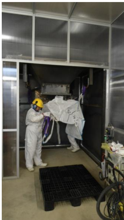
Mise en place d'un big bag sous une trémie
